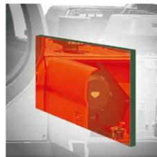
FIREWALL INSTALLED BETWEEN THE ENGINE AND PUMP
